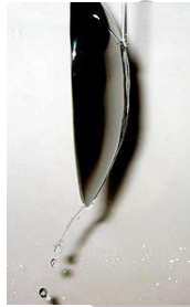
Abb. 5: Wasserstrahl wird durch Form des Löffels abgelenkt 23
